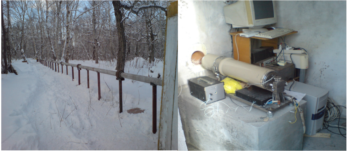
Рис. 30. Лазерный интерферометр-деформограф размещенный в ИКИР ДВО РАН. Температурный коэффициент для такого деформографа оценивается величиной:
