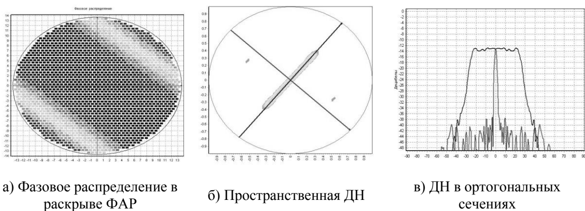
Рис.3. Пример формирования секторного луча в наклонной плоскости.
