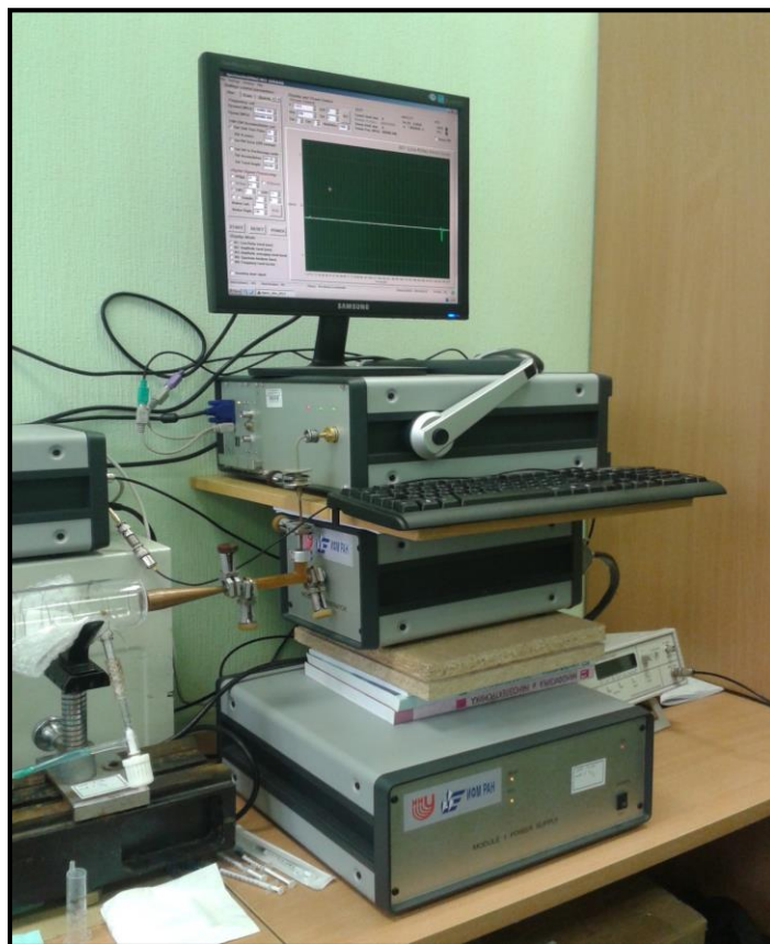
Рис. 3. Источники излучения двухчастотного ТГц спектрометра.
