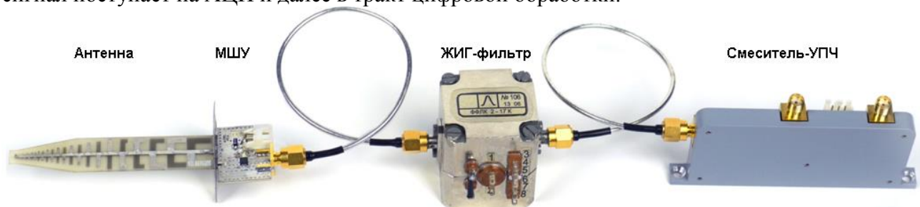
Рис. 6. Аналоговый канал цифровой гибридной антенной системы
