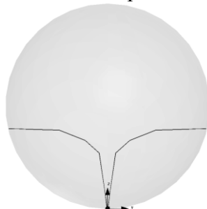
Рис. 7. Конструкция ТЕМ рупора, сечение в E -плоскости
