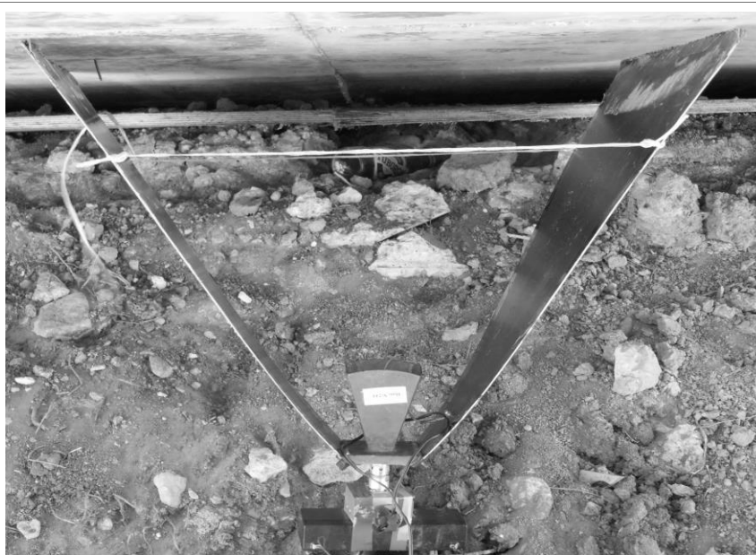
Рис. 1 – Излучающая «на просвет» антенна м- диапазона с ДДРВ генератором и
