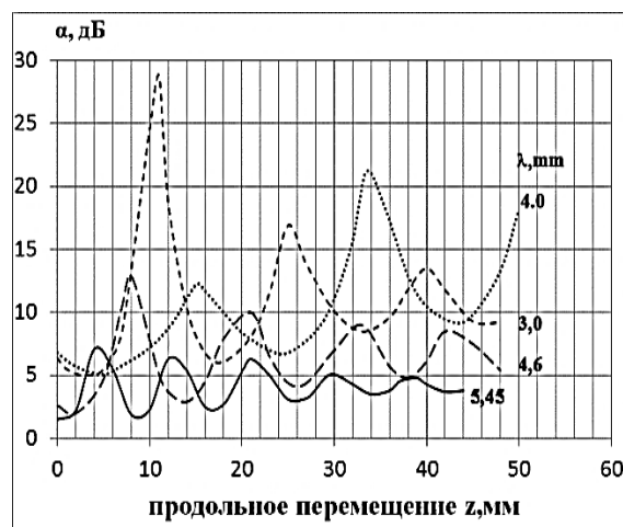
Рис. 2. Ослабление двух монослоев с регулярными структурами при x=0 (полиэтиленовые гранулы d=5 мм, ребро ячеек l=5,35 мм).
