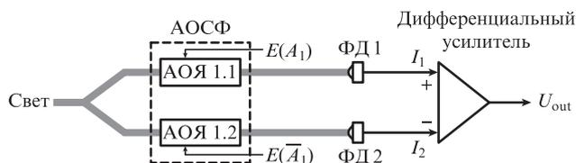
Рис.2. Схема балансного АО приемника для абонента 1.
