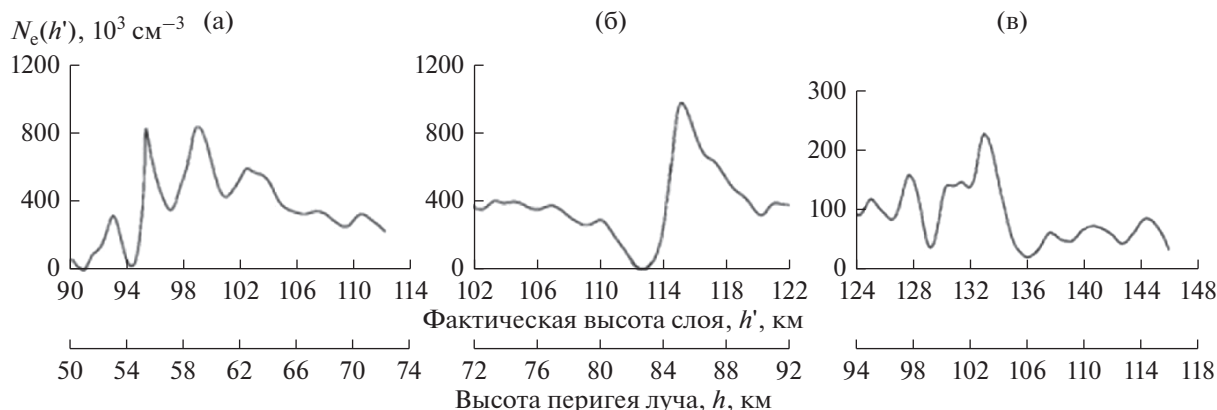
Рис. 3. Результаты определения электронной плотности для трех ионосферных слоев. Смещение, высотная поправка и угол наклона слоя равны, соответственно: d = -730 км, \Delta h = 40 км и \delta = -7.3^\circ (слой a , панель (а)); d = -620 км, \Delta h = 30 км и \delta = -6.4^\circ (слой b , панель (б)); d = 620 км, \Delta h = 30 км и \delta = 6.4^\circ (слой c , панель (в)).
