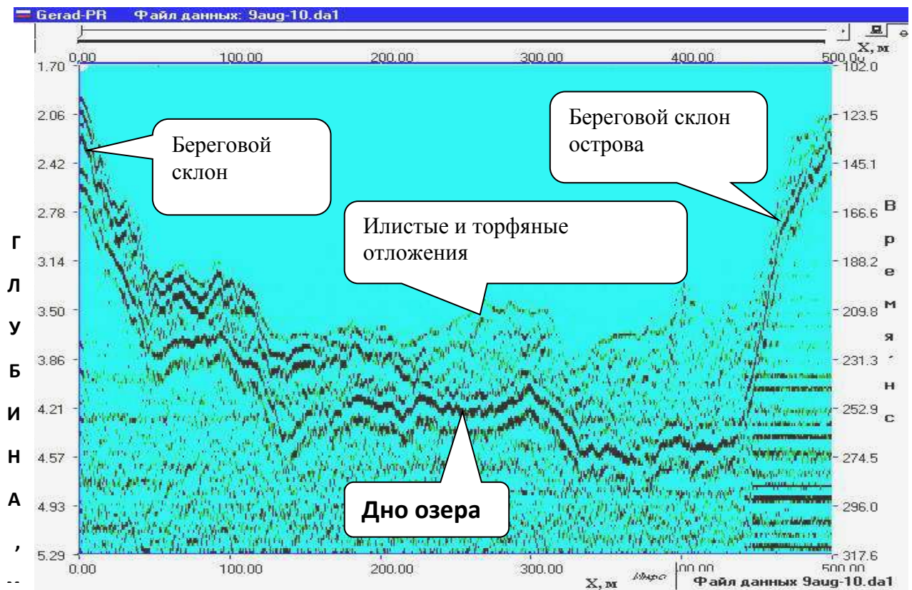
Рис.3. Результаты профилирования дна озера Большое георадаром Герад 3 (200 МГц).
