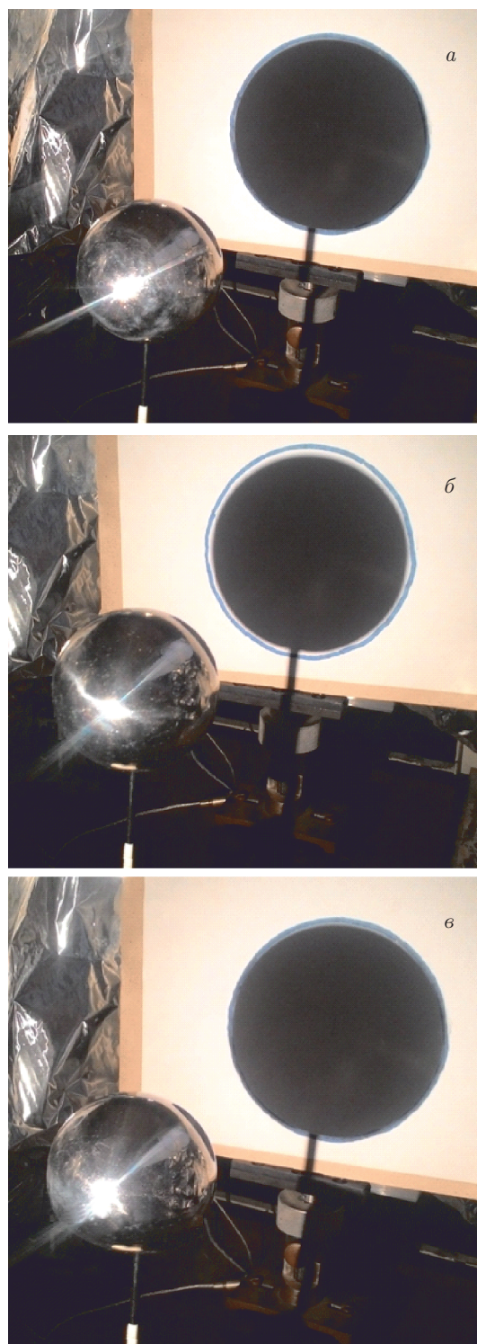
Рис. 6. (В цвете онлайн) Изображения высокоотражающих шаров. Шар без покрытия (а), шар с покрытием толщиной d_2 = 13 мкм (б), шар с покрытием толщиной d_2 = 15 мкм (в). Синим контуром обведена площадь поверхности тени от шара без покрытия
