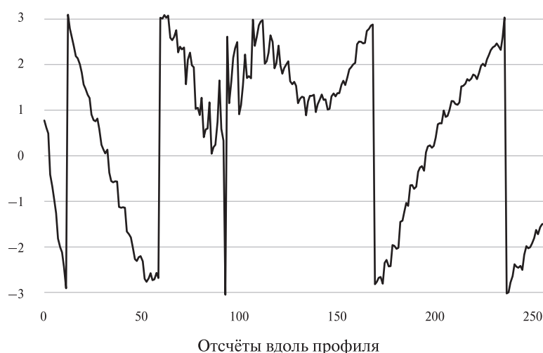
Рис. 2. Профиль фазы вдоль Третьего Босфорского моста для пары 3–15 марта; по горизонтали — номера отсчётов вдоль профиля, по вертикали — фаза в рад
