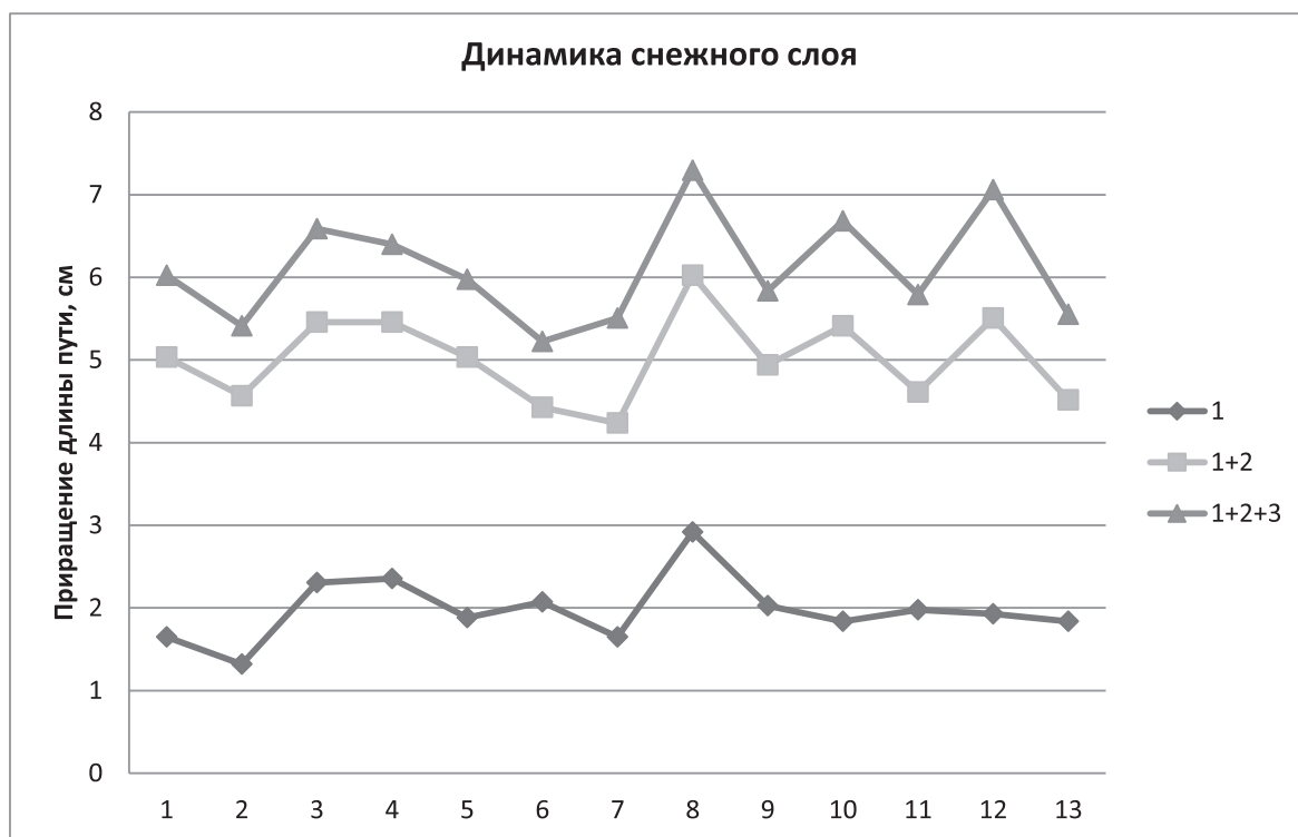
Рис. 7. Приращение длины пути сигнала в слое снега по измерениям с использованием эхо-сигналов 13 опор ЛЭП в период 24 ноября 2014 г. – 19 января 2015 г.
