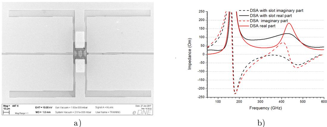
Рис. 3. а – вид используемой двойной щелевой антенны, б – расчет действительной и мнимой частей импеданса используемой двойной щелевой антенны
