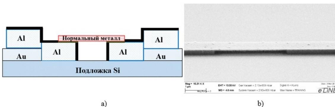
Рис. 1. а – схематическое изображение предлагаемой конструкции болометра, б – СЭМ-изображение изготовленной СИНИС-структуры, снятое под углом 60 градусов. Толщины слоев: Al – 80 нм,  $\text{Al}_2\text{O}_3$  – 1 нм,  $hf$  – 20 нм
