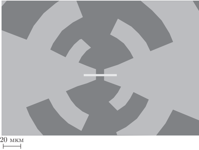
Рис. 1. Электронно-микроскопическое изображение болометра, интегрированного в логопериодическую антенну
