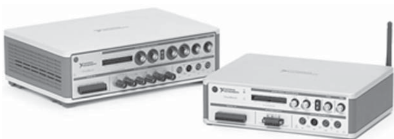
Рис. 5. Измерительная лаборатория компании National Instruments (6 лабораторных комплектов генераторов и осциллографов-спектроанализаторов)
