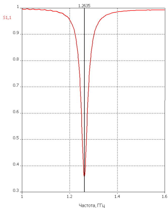
Рис. 1.7.5. Расчетная частотная характеристика ПА со всеми зубцами
