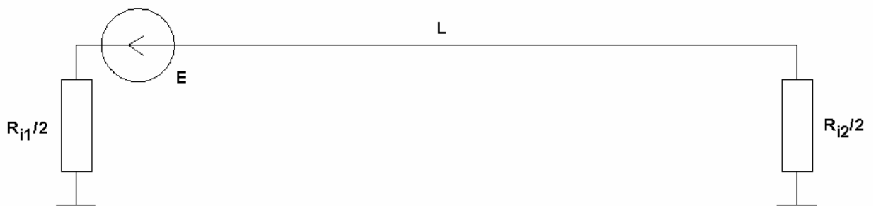
Рис. 5.2.10. Эквивалентная схема четвертьволновой КСА
