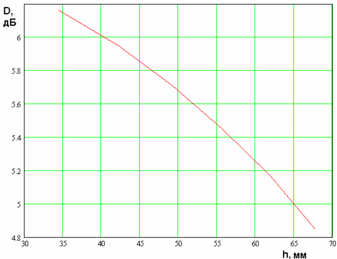
Рис. 5.1.5. КНД полуволновой КСА
