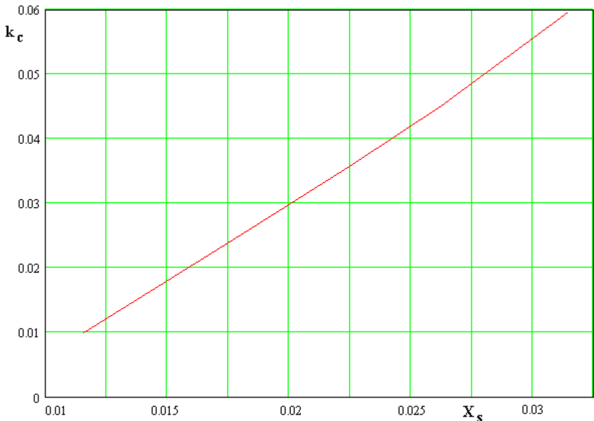
Рис. 4.2.16. Зависимость коэффициента связи от нормированного сопротивления X_s
