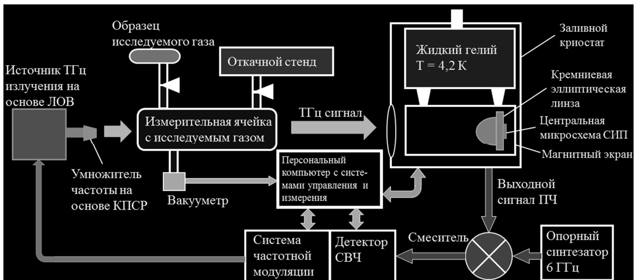
Рис. 4. Принципиальная схема лабораторного спектрометра для исследования линий поглощения газовых смесей в ТГц диапазоне на основе СИП.
