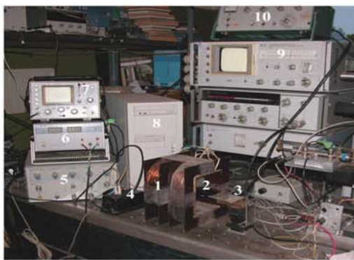
Рис. 3. Стенд для исследования и оценки восприимчивости к магнитным полям композитных материалов
