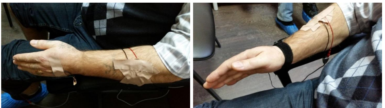
Рисунок 4.3. Электроды ЭМГ и датчики акселерометра на левой руке (слева) и на правой руке (справа) в состоянии позной активности конечностей испытуемого. На правой руке также установлена «земля».
