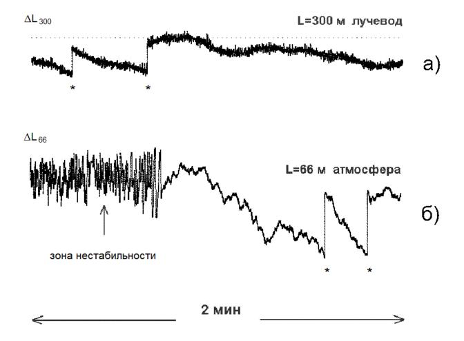
Рис 3. Записи вариаций оптической длины, зарегистрированные интерферометрамидеформографами: а — длина базы 300 м, подземный лучевод; б — 66-метровый интерферометр в открытой атмосфере; \* — отмечены автоматические переносы начала отсчета системы регистрации на величину N = (3, ...8) периодов интерферограммы.
