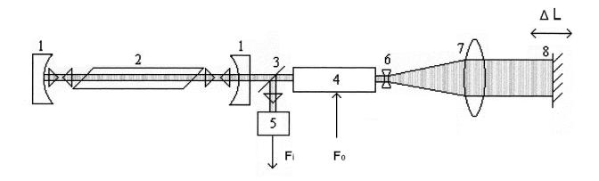
Рис.2. Оптическая схема трехзеркального лазерного интерферометра-деформографа: 1— зеркала лазера, 2 — рабочая среда лазера, 3 — светоделительная пластинка, 4 — электрооптический модулятор, 5 — фотоприемник, 6, 7 — линзы согласующего телескопа, 8 — измерительное зеркало.
