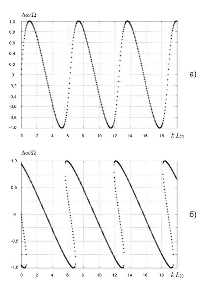
Рис.1. Сдвиг частоты в трехзеркальном лазерном интерферометре при изменении длины  $L_{23}$ : а — связь меньше критической; б — связь больше критической; по оси ординат отложена безразмерная величина  $\Delta\omega/\Omega$ , где  $\Omega=\frac{c|\mathbf{r}_3||\mathbf{t}_2|^2}{2L_{12}|\mathbf{r}_2|}$ .
