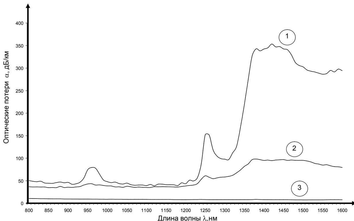
Рис. 15. Оптические потери после цикла нагрев-охлаждение ОВ с покрытием из алюминия, в зависимости от вещества легирования: 1 -  $\text{GeO}_2+\text{P}_2\text{O}_5$  (125 мкм), 2 -  $\text{GeO}_2$  (200 мкм), 3 – начальные потери в ОВ с покрытием из алюминия легированного  $\text{GeO}_2+\text{P}_2\text{O}_5$ .
