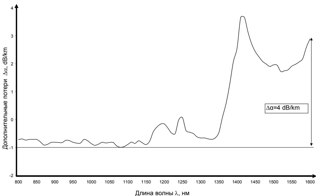
Рис. 17. Изменение оптических потерь в металлизированном ОВ с покрытием из алюминия после 15 месяцев хранения при температуре  $20\text{ }^{\circ}\text{C}$ .
