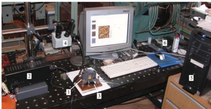
Рис. 2. Фотография стенда для исследования мультиферроидных магнитных структур: 1 – атомный силовой микроскоп (АСМ); 2 – блок сопряжения АСМ с ПК; 3 – образец диска НЖМД; 4 – микроскоп МБС-10; 5 – ПК с набором приводов для записи информации; 6 – наборы кантиллеров и калибровочные решётки
