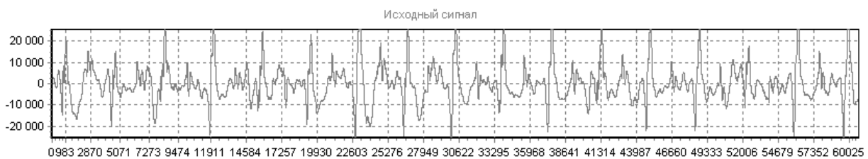
Рисунок 1 – исходный акустический сигнал, получаемый в ходе исследования.
