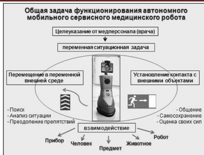
Рисунок 1 - Парадигма функционирования сервисных медицинских роботов в клинике.
