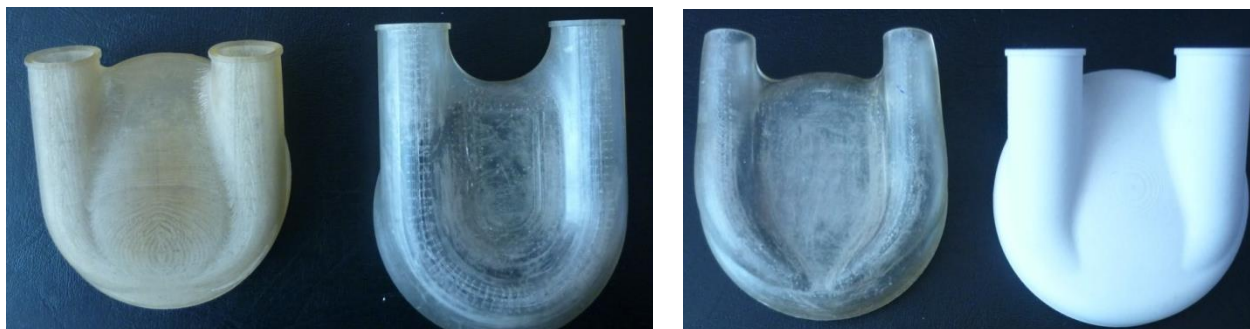
Рис. 1. Физические модель ИЖС, полученная методом лазерной стереолитографии на установке ЛС-250
