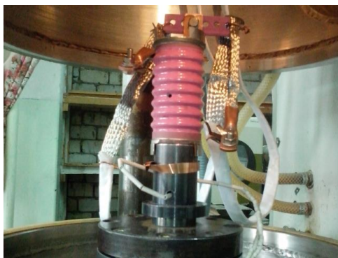
Рис. 4. Камера установки УДС-2 с установленной быстросъемной системой нагрева
