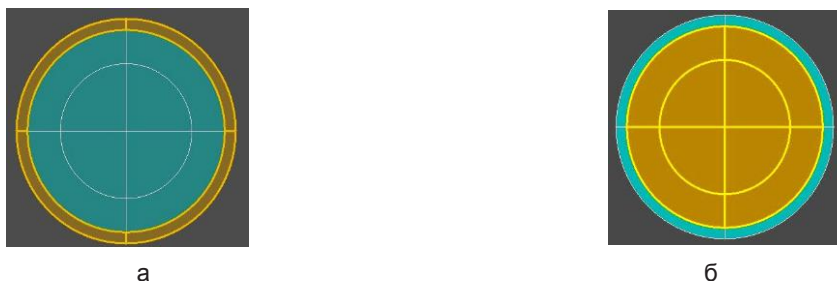
Рис. 5. Плоскости с разными меш-генераторами для построения сетки конечных элементов: а – типа Mapped ; б) типа Automatic
