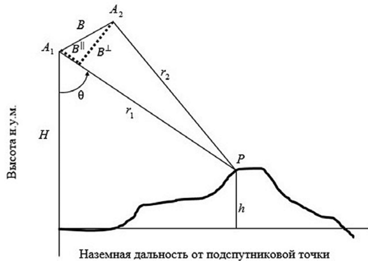
Рис. 1. Геометрия интерферометрической съемки. Обозначения: A_1 и A_2 — точки съемки первого и второго изображения; P — снимаемая точка на земной поверхности; h — ее высота над некоторой референсной поверхностью; B — расстояние между точками съемки (база интерферометра); H — высота орбиты в первом сеансе съемки; \theta — угол обзора
