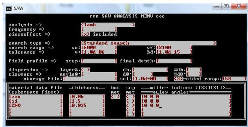
РИС.2.3. Снимки с экрана PC программы при расчете скорости волн Лэмба в трехслойной структуре пленка ZnO/пластина Si/пленка ZnO.
