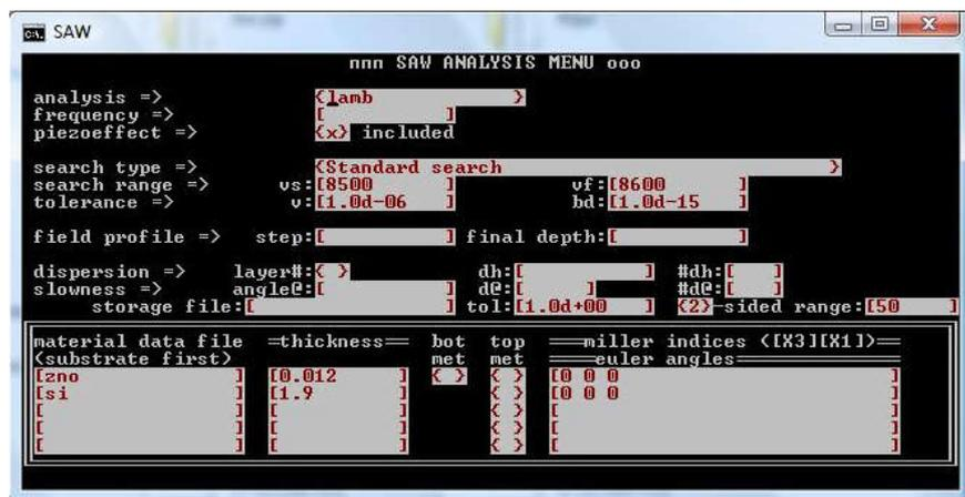
РИС.2.2. Снимки с экрана PC программы при расчете скорости волн Лэмба в двухслойной структуре пленка ZnO/пластина Si.
