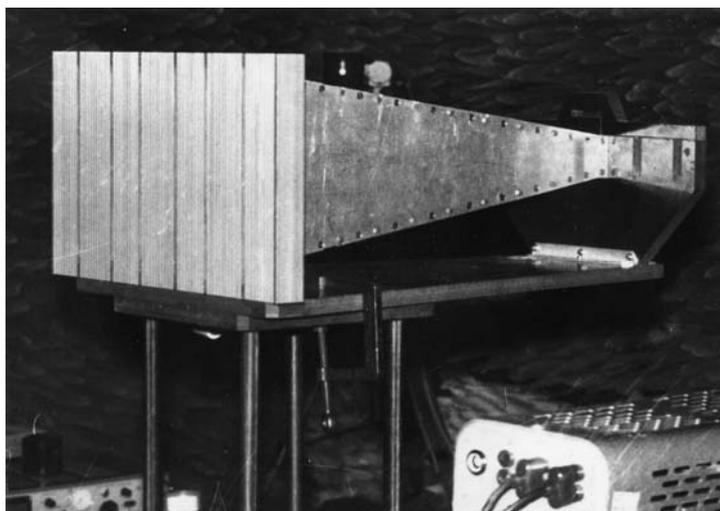
**Рис. 4.10.** Макет антенной решетки X-диапазона с ребристой структурой.
