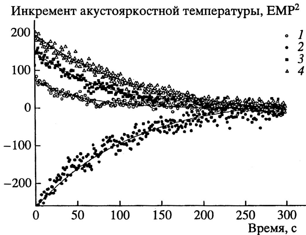
Рисунок 3.2: Калибровочные кривые. Зависимости (1-4) инкремента акустяркостной температуры акустического черного тела (пластилина) от времени при различных температурах аквариума (22,1; 33,4; 13,0; 19,0 °C) и начальных температурах пластилина (28,5; 12,3; 32,5; 36,3 °C, соответственно).
