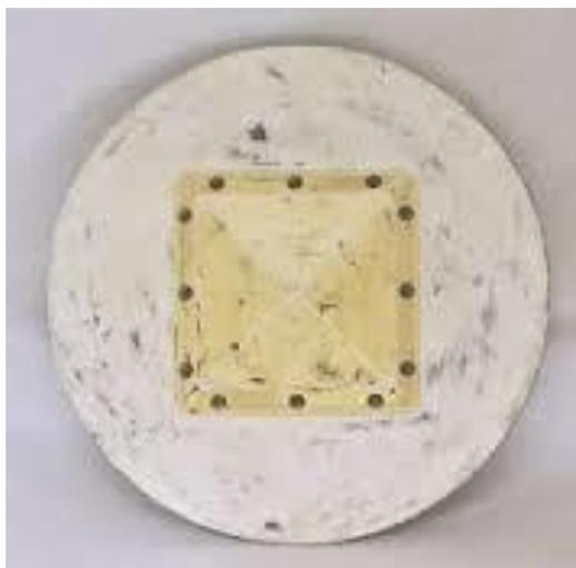
**Рис. 59.** Экспериментальный макет пэтч-антенны с металлическим экраном.
