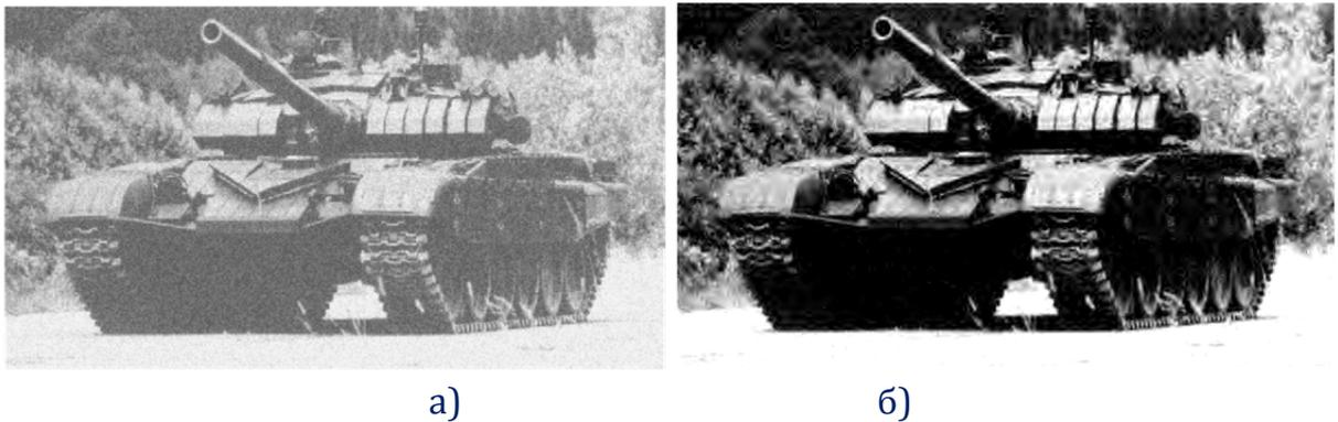
**Рис. 2.8.** Зашумленное изображение «Танк Т72» (а), восстановленное изображение системой  $\{\widetilde{h}_{2,1}\}$  (трешхолдинг 0.25) (б).
