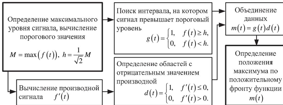
**Рис. 19.** Блок-схема поиска максимума функции.
