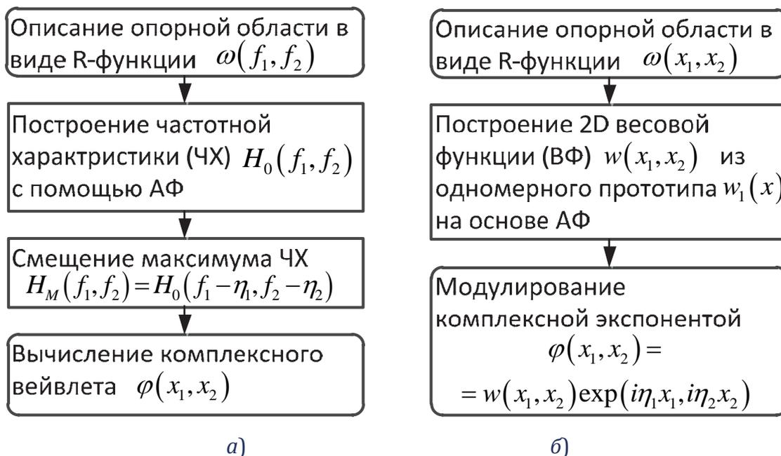
**Рис. 12.** Блок-схемы алгоритмов синтеза аналитических 2DWA со сложной геометрией опорной области в частотном (а) и временном (б) пространствах.
