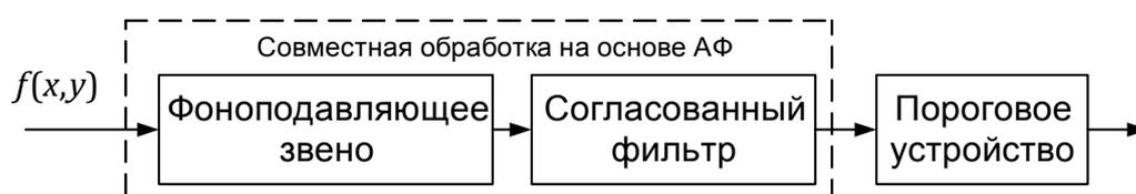
Рис. 23. Структурная схема обнаружителя границы изображения.
