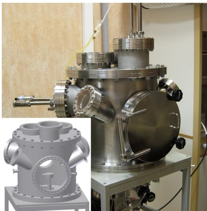
**Рис. 1** Фотография разработанной и собранной автором установки магнетронного распыления. На вставке показана трехмерная модель вакуумной камеры, подготовленная на этапе разработки схемы установки для передачи на производство.
