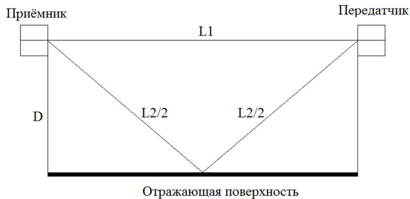
Рисунок 3.8.1 – Схема экспериментальной установки
