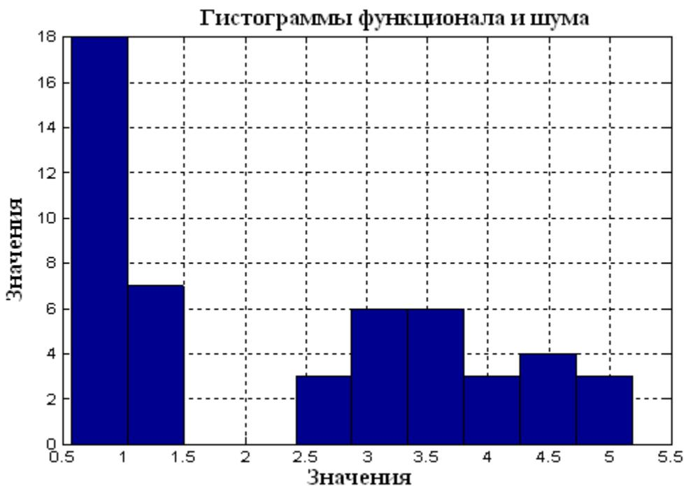
Рисунок 3.3.5 – Гистограммы максимумов функционалов отношений правдоподобия при наличии сигналов в реализации и при их отсутствии
