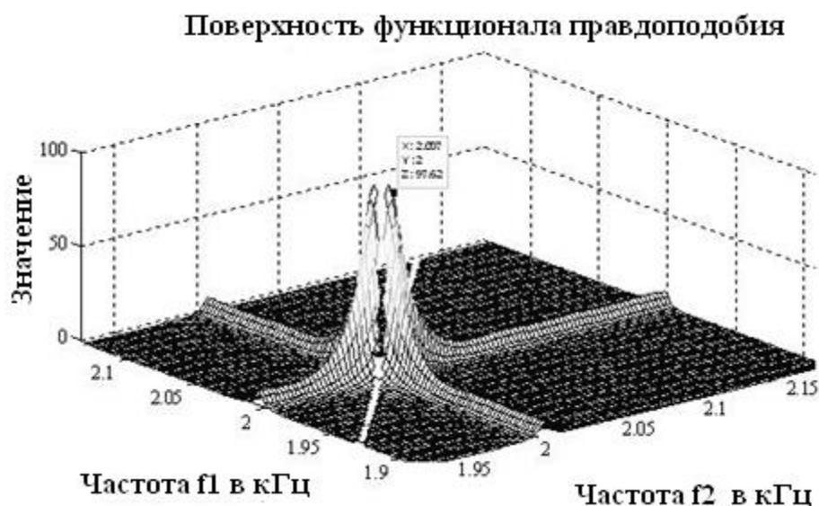
Рисунок 1.3.5 – Поверхность преобразованного обратного функционала правдоподобия. Разность частот радиоимпульсов 5 Гц, область высокой корреляции
