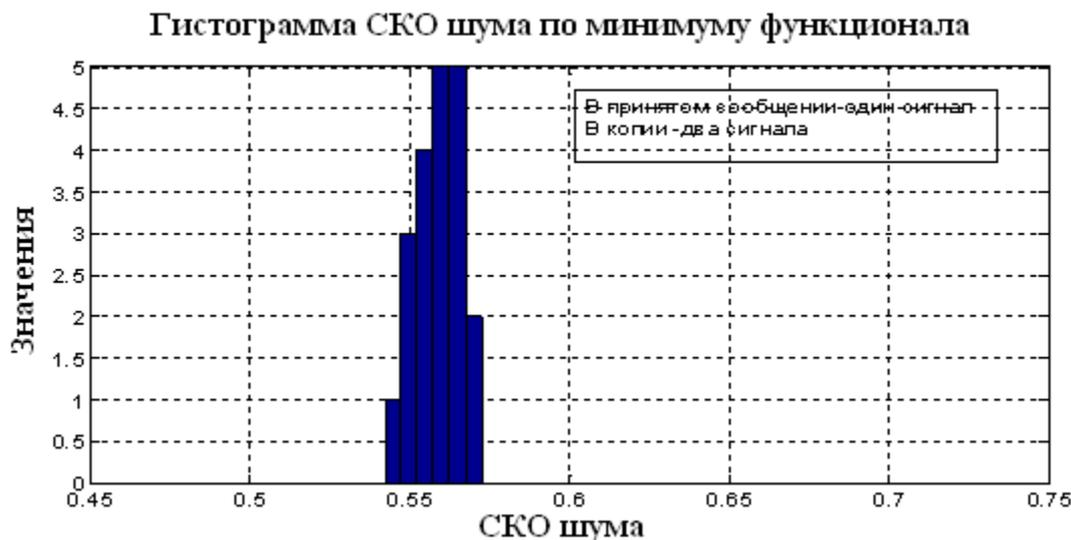
Рисунок 3.4.1 – гистограмма СКО шума ( $\sigma$ ) для случая: в принятой реализации содержится один сигнал, в копии содержится два сигнала. Среднее СКО шума 0,556
