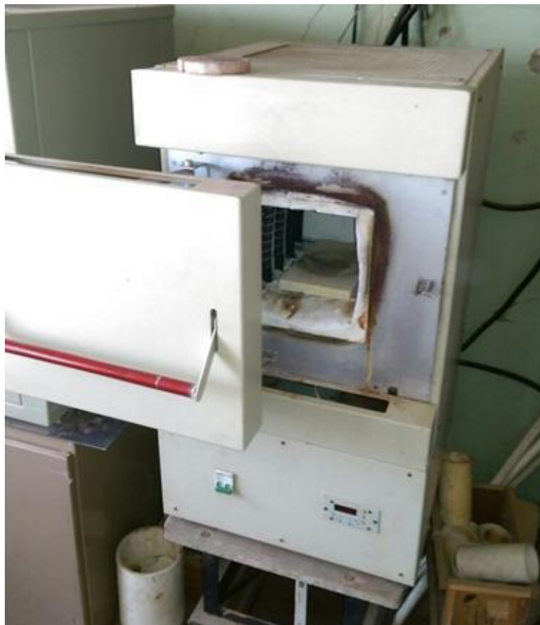
Рис. 2.1. Лабораторная печь ШОЛ 12/16.
