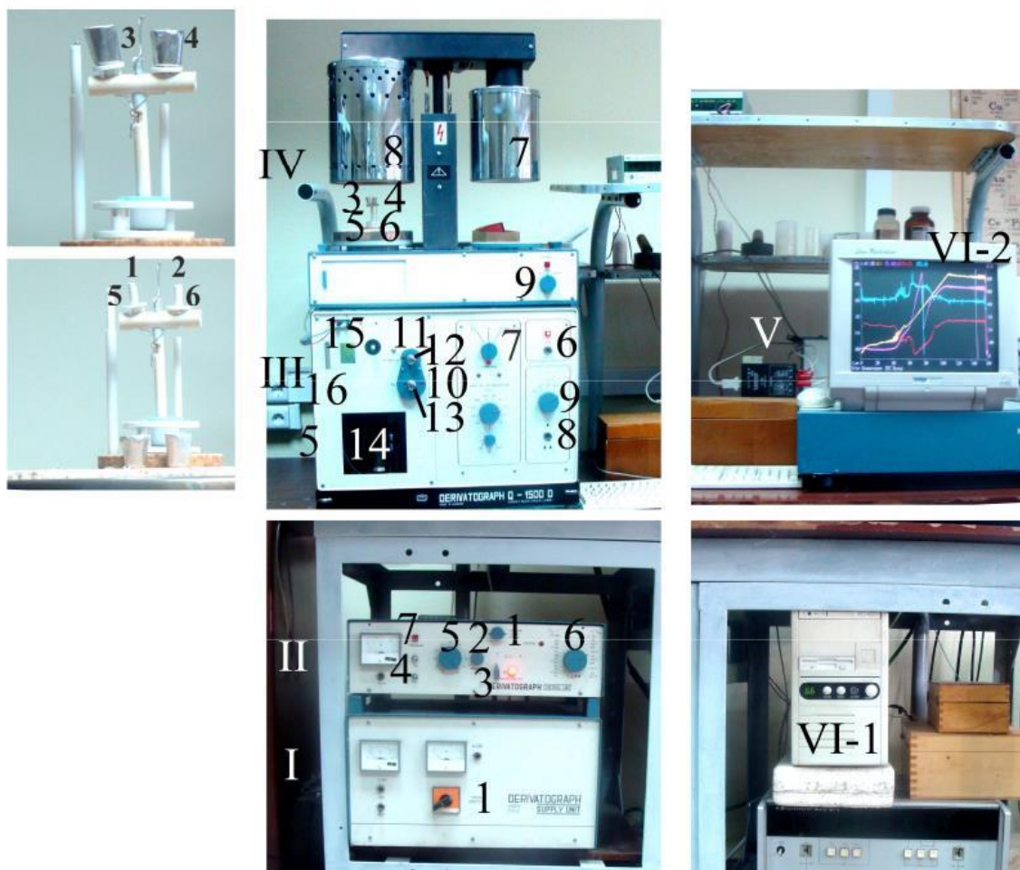
Рис. 2.4. Модернизированный дериватограф Q 1500 D системы «Paulik-Paulik-Erdei». I - блок питания, II – блок программного регулятора нагрева, III - блок термовесов (III - 1 - весы; III - 2 - дифференциальный трансформатор преобразования ТГ; III - 3 – магнит; III - 4 – катушка), IV - блок печей (IV – 1, 2 – термопары; IV - 3, 4 – тигли для пробы и для инертного вещества, IV - 5, 6 – керамические трубки, IV - 7(8) - печь), V - модуль АЦП, VI - персональный компьютер.
