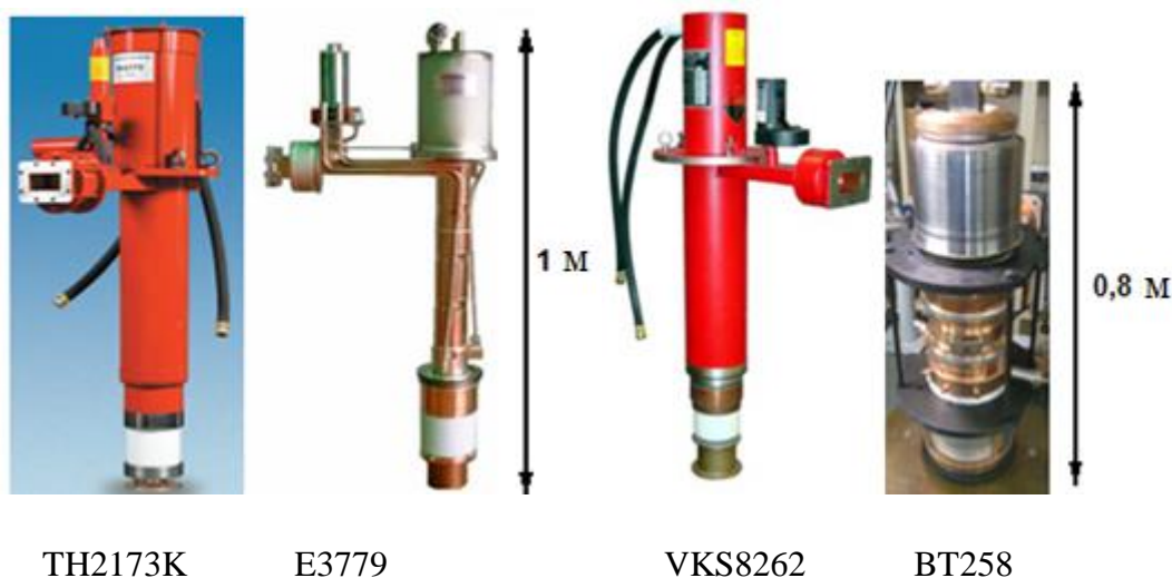
Рис. 5.34. Прототипы клистронов Toshiba, CPI, Thales, БТКВП.
