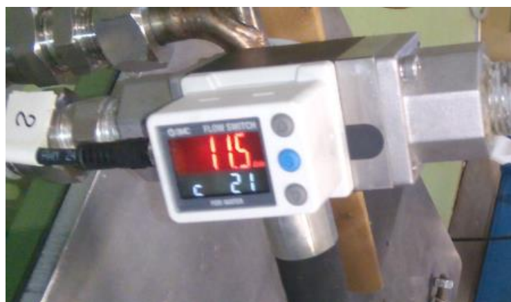
Рис. 5.30. Поток воды в аноде.
