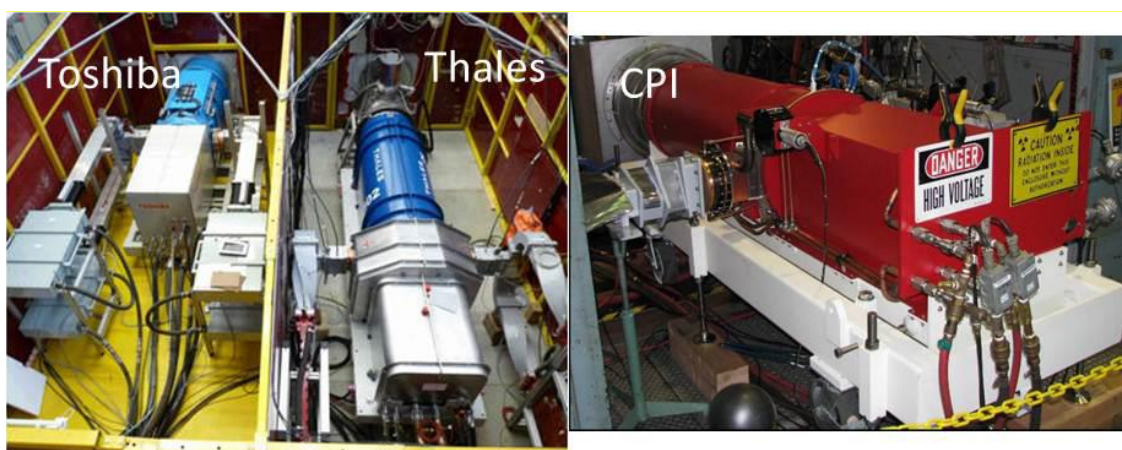
Рис. 1.1. Многолучевые клистроны трёх производителей а) Toshiba E3736 б) Thales TH-1802 в) CPI VKL-8301B.
