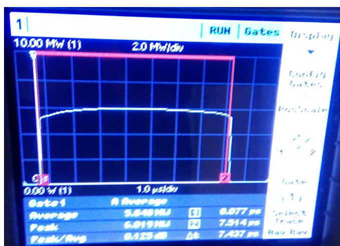
Рис. 5.27. Осциллограмма импульса выходной мощности.
