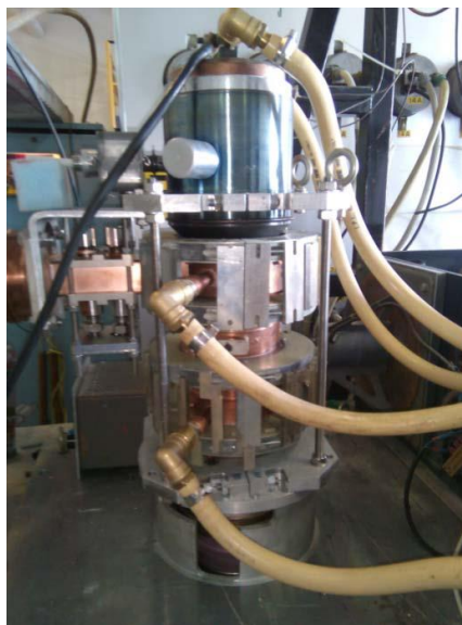
Рис. 5.11. БАК многолучевой клистрон на испытательном стенде.
