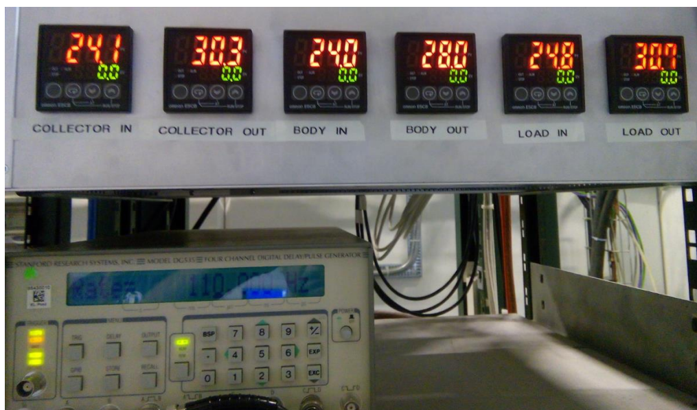
Рис. 5.28. Входная и выходная температуры коллектора, анода и нагрузки.
