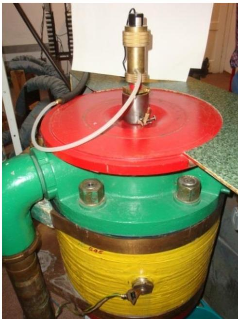
Рисунок 2.3 – Фотография разработанного оптического микроскопа в биттеревском магните.
