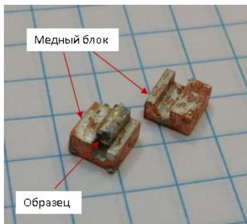
Рисунок 2.6 – Медный блок с образцом для измерения изотермического поглощения/ выделения тепла
