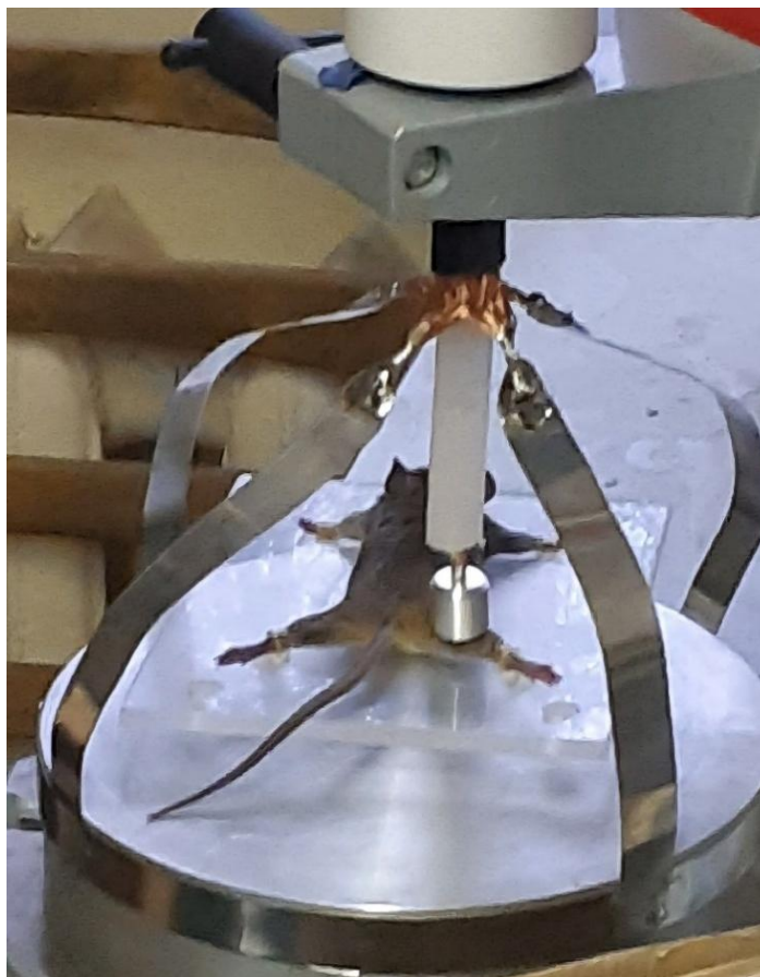
Рисунок 2.5. Лабораторная мышь на подложке из оргстекла, помещённая между верхним и нижним электродами в экспериментальной установке.
