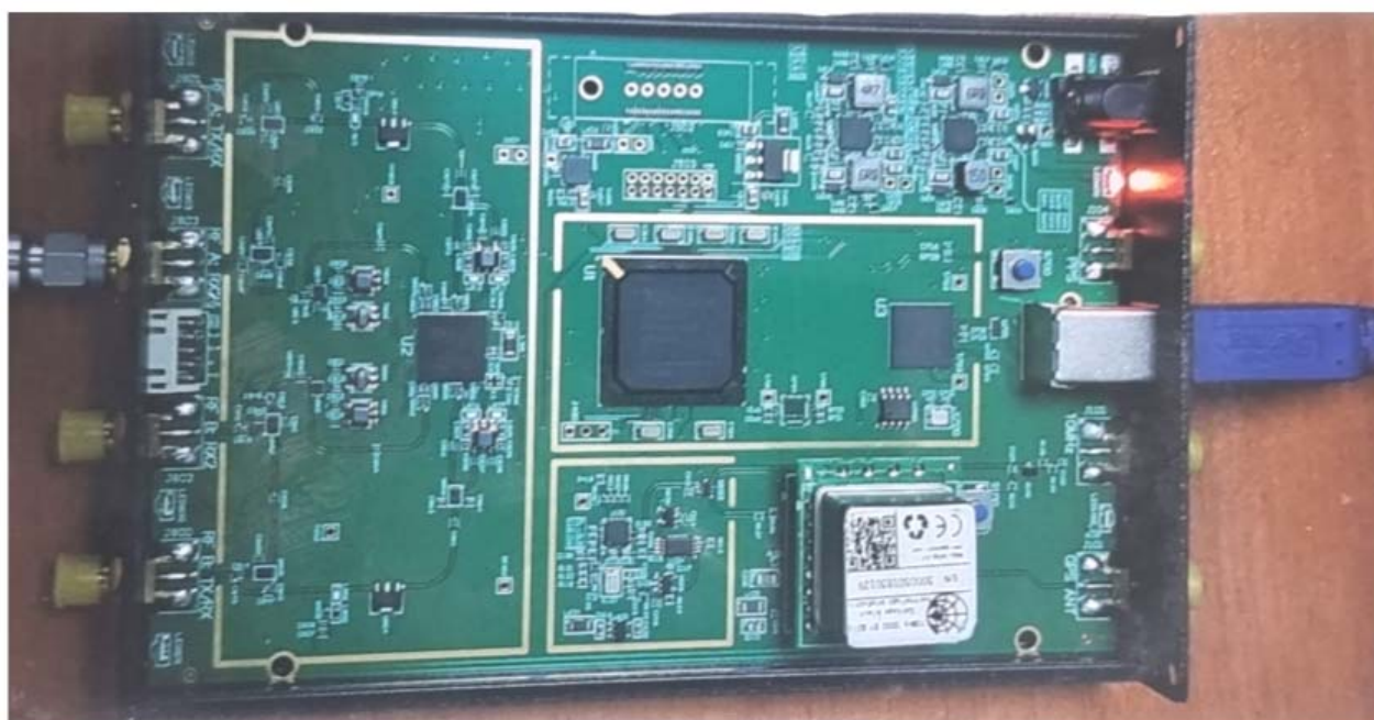
Рис.5.5 Вид платы SDR (Soft Define Radio: передатчик/приемник) в составе разработанного модуля экспериментальных исследований с использованием спутников-ретрансляторов сигналов P/L - частотных диапазонов спутниковой системы Коспас-Сарсат.
