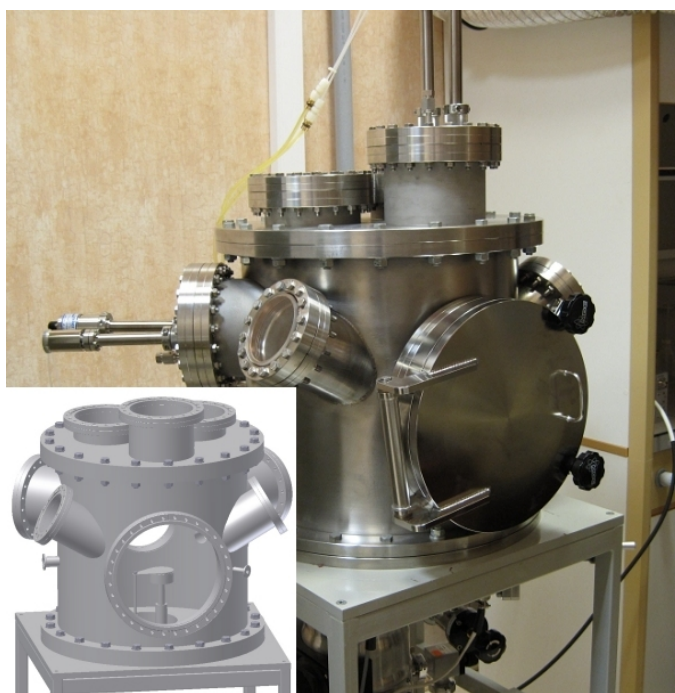
Рис. 1 Фотография разработанной и собранной автором установки магнетронного распыления. На вставке показана трехмерная модель вакуумной камеры, подготовленная на этапе разработки схемы установки для передачи на производство.
