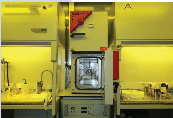
*Ламинарные боксы с системой HEPA-фильтров и сушильные печи с принудительной циркуляцией воздуха.*
