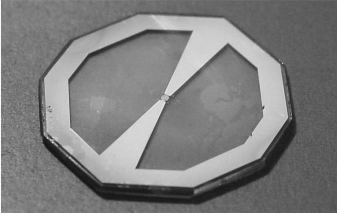
Рис. 4. Фотография ВТСП СКВИД градиентометра с многослойным трансформатором потока и длиной базы около 1 см.
