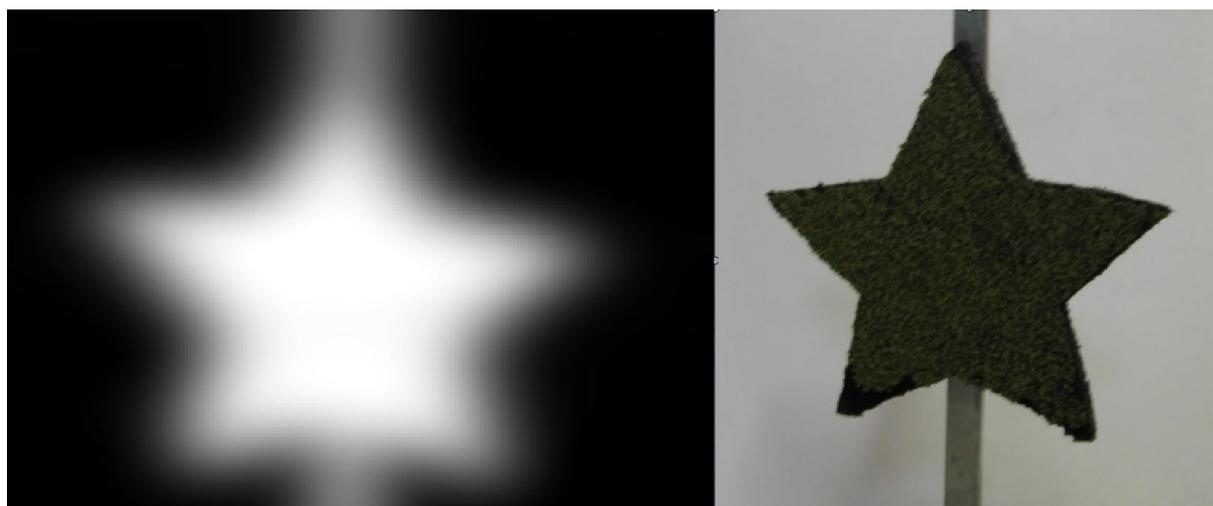
**Рис. 3.13.** Терагерцовое изображение тестового объекта «звезда» и его изображение в оптическом диапазоне.
