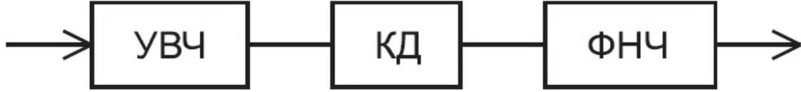
**Рис. 1.12.** Блок-схема приемника прямого усиления. На схеме блоками показаны усилитель высоких частот (УВЧ), квадратичный детектор (КД) и фильтр низких частот (ФНЧ).
