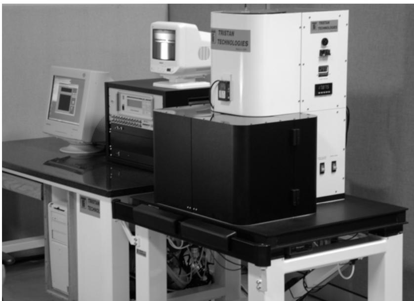
*Рис. 5. Фотография ССМ фирмы Tristan Technologies inc., содержащего в качестве чувствительного элемента разработанный и изготовленный в Юлихе ВТСП СКВИД.*
